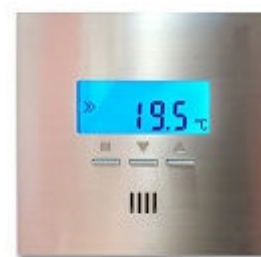
RGM – sonde MELJAC en version programmable avec afficheur
